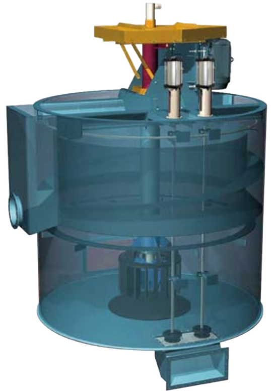
▲ Celda de flotación / Floatation tank
