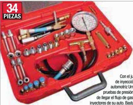
Con el juego de probador de inyección de combustible automotriz Urrea, usted realiza pruebas de presión antes y después de llegar el flujo de gasolina a la serie de inyectores de su auto. Basta con que conecte el extremo de la manguera de flujo de gasolina proveniente del inyector.
