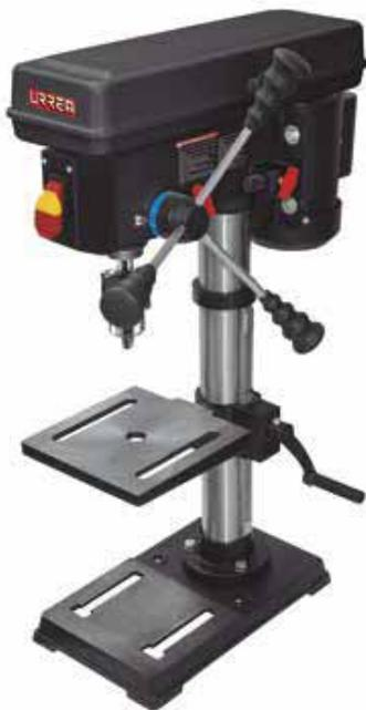
La muestra se ajusta para perforar piezas de trabajo de diferente grosor.
