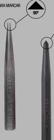
Los puntos a 50° se utilizan para marcar las piezas durante el proceso de fabricación o ensamble. Los puntos a 90° se usan para centrar el punto de barrenado y evita que la broca se deslice.
