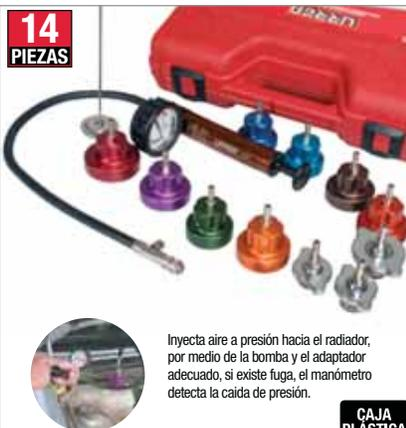
Inyecta aire a presión hacia el radiador, por medio de la bomba y el adaptador adecuado, si existe fuga, el manómetro detecta la caída de presión.
