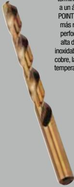
Brocas de alta duración y terminado dorado con punta a un ángulo de 135° SPLIT POINT que permite un corte más rápido y preciso en la perforación de metales de alta dureza como el acero inoxidable, fundición, aluminio, cobre, latón, aleaciones a altas temperaturas, titanio y algunos plásticos.
