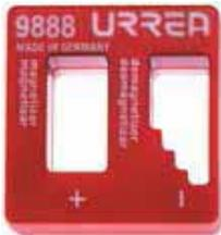
Para imantar la punta del destornillador introduzcala en la cavidad del polo positivo, así obtendrá una función que le permitirá la colocación de tornillos en lugares estrechos, sacarlos si es que se le han caído, y si lo que requiere es trabajar con partes electrónicas que requieren herramientas desmagnetizadas introduzca la punta en la cavidad del polo negativo.
